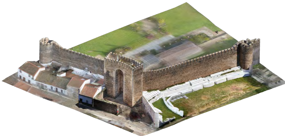
Figura 2. Modelo de malla texturizada del ámbito de la puerta de San Miguel.
